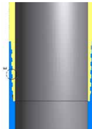
Profil gwintu rur płuczkowych ATW, BTW i NTW
