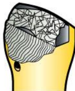
F6 Wzdłużne odłamanie ostrza oraz brak jednego boku głowicy wiertła
