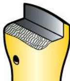
F6 Wzdłużne odłamanie ostrza oraz brak jednego boku głowicy wiertła
